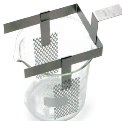
Abb. 8: Becherglasanoden für Beschichtungen von Musterteilen und Abscheideversuche im Labormaßstab
