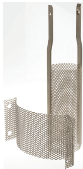
Abb. 3: Pt/Ti-Anoden aus Streckmetallgitter. Bauformen und Maschenabmessungen sind auf die zu beschichtenden Bauteile optimiert. Die Streckgitter erlauben eine optimale Elektrolytbewegung. Die Abstände zwischen Anode und kathodischem Bauteil können sinken, die Stromdichte lässt sich erhöhen. Prozesse werden so deutlich schneller. Das Resultat: bessere Qualität in kürzerer Zeit
